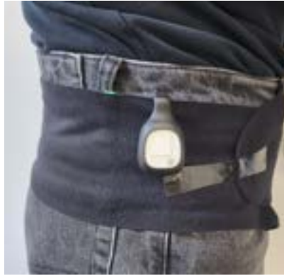
Figure 3.3: Dispositif eGait porté à la hanche droite à l'aide d'une ceinture.
