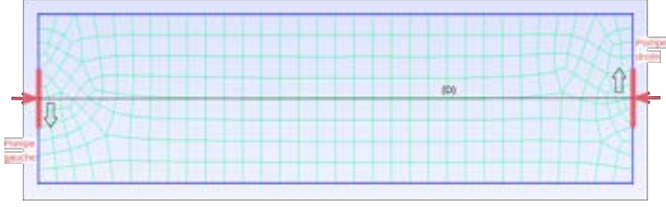
FIGURE 8 – Visualisation du maillage ainsi que l'emplacement des pompes sources sur une tranche de la dalle en deux dimensions. Les flèches rouges indiquent la direction du déplacement imposé par les sources. Les flèches grises indiquent que la position des sources peut être ajustée verticalement.
