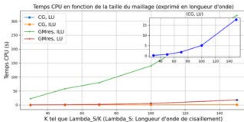
FIGURE 11 – Temps de résolution CPU en fonction du pas du maillage (les courbes bleue (CG, LU) et rouge (GMRES, LU) sont confondues)
