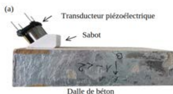
FIGURE 29 – Photo du dispositif expérimental de génération d'ondes de surface
