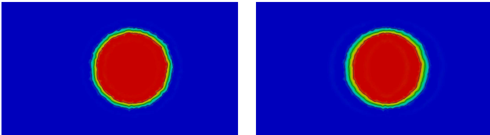
FIGURE 2.14 – Solution zoomée et courbes de niveau de 0.1, 0.5, 0.9 pour k = 2 avec une CFL de 0.5 (gauche) et 10 (droite)
